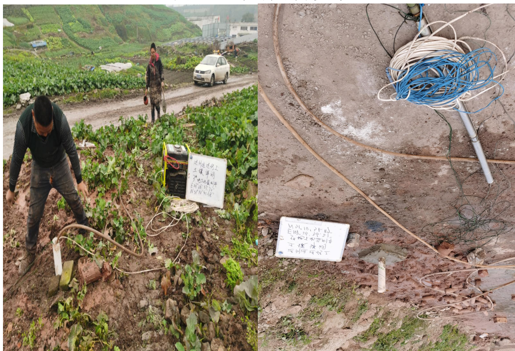
图 6.1-8 现场洗井实景
